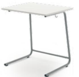
**Gestell** C-förmig gebogenes Präzisions-Federrundstahlrohr ( $\emptyset$ -außen = 30 mm) mit fest verschweißter Queraussteifung aus Rundstahlrohr ( $\emptyset$ -außen = 28 mm).
