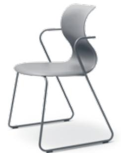
**Gestell** Gleitkufengestell mit Armlehnen aus gebogenem Präzisions-Federrundstahlrohr ( $\emptyset = 14 \times 2 \text{ mm}$ ) mit fest verschweißter Queraussteifung aus Rundstahlrohr ( $\emptyset = 14 \text{ mm}$ ) unter der Sitzschale.
